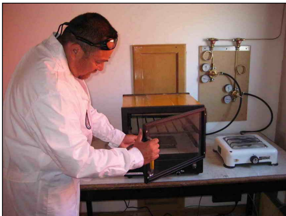
Anafe y horno para cocción de alimentos utilizando el hidrógeno producido por el MAEL I
