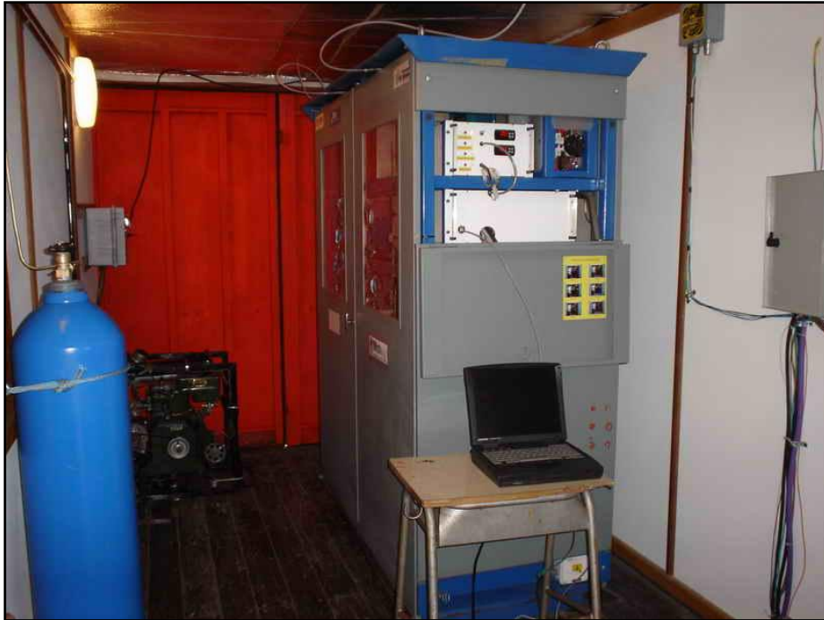
Vista interior del MAEL I donde se observa el electrolizador comandado por PC y el llenado de un tubo de oxígeno a presión
